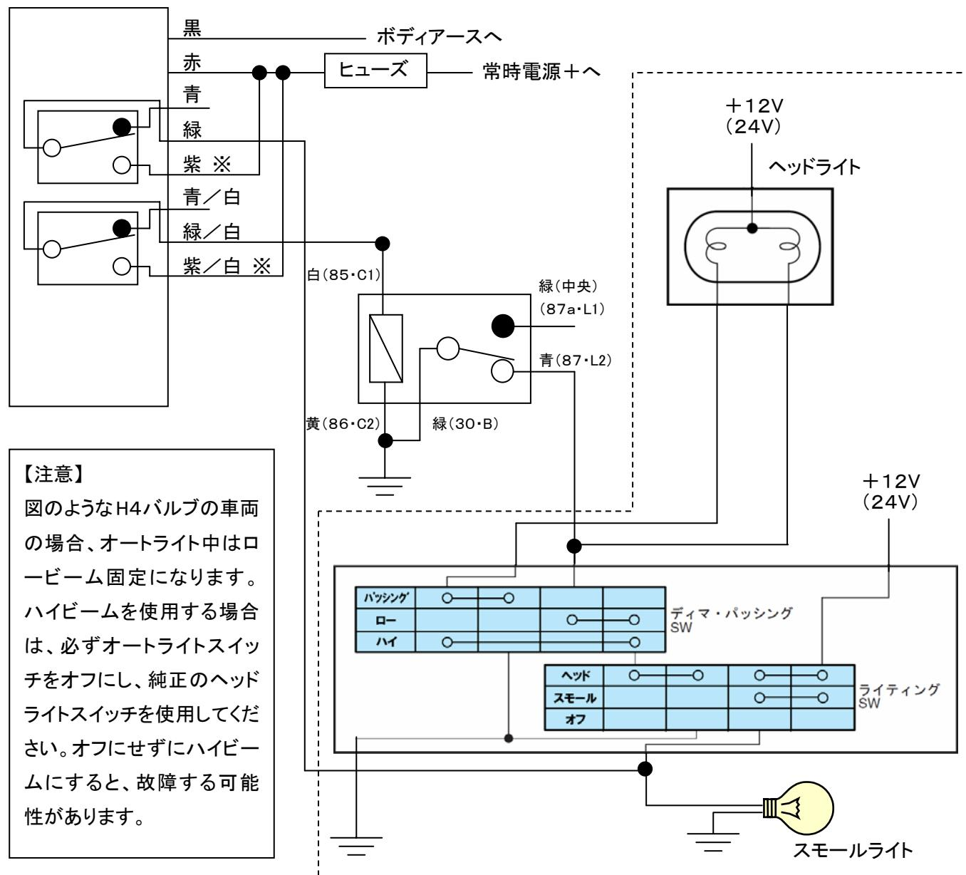
※ 配線例の紫はスマートが+コントロール(スマートを点けた時に+12V(24V)とつながる)の場合。-コントロールの場合は①黒線へ接続。
