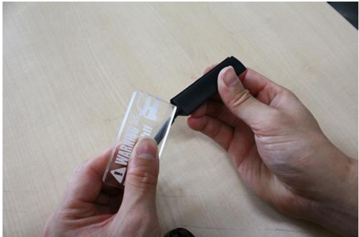
アクリルの角をマウントの溝に横(配線が出ている方)から差し込みます。
