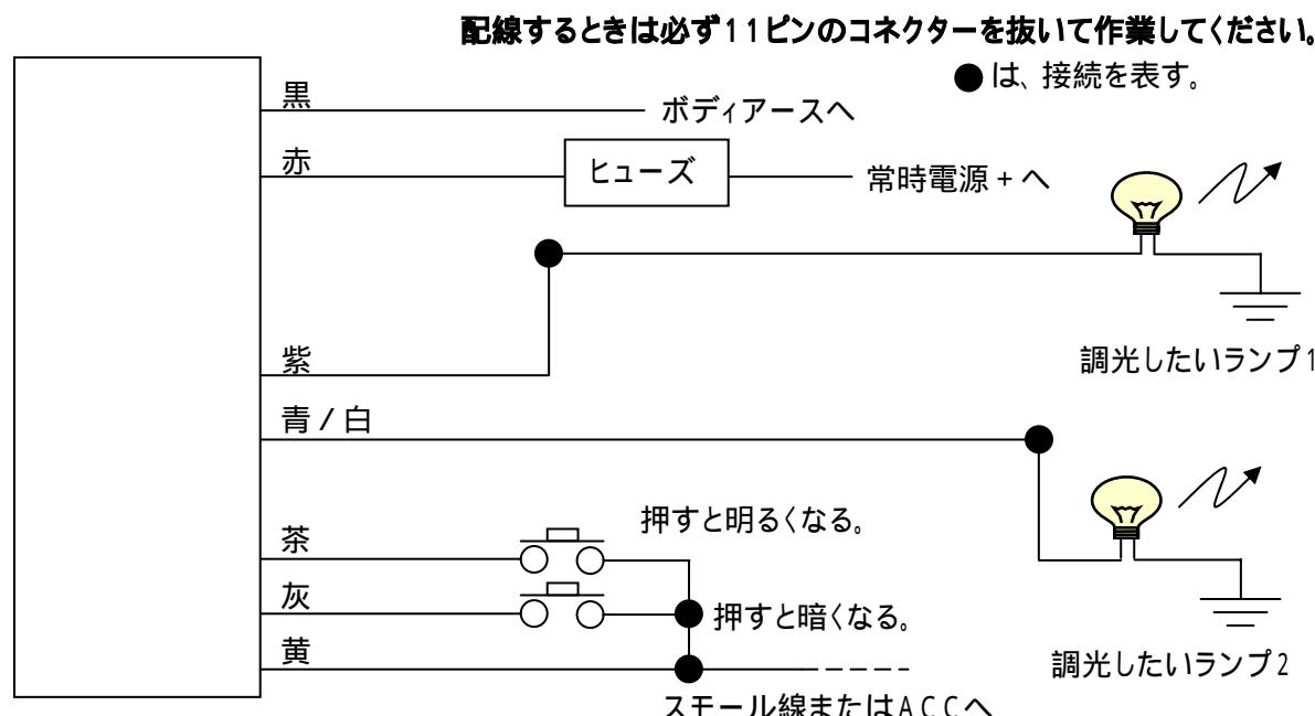
当社の3ch汎用リモコンスイッチと接続する場合は、茶線とリモコンスイッチの黄線、灰線とリモコンスイッチの緑線と接続し、リモコンスイッチの橙線と紫線はスモール線またはACCへ接続してください。のボタンで明るく、のボタンで暗くなります。
